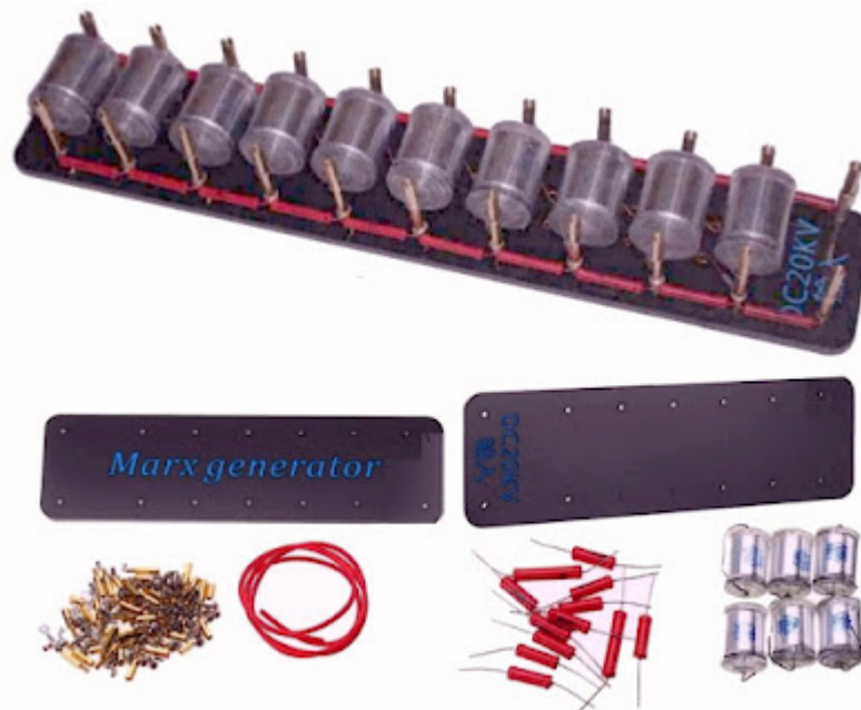
Een bouw pakket van een Marx-generator. (© Banggood)
